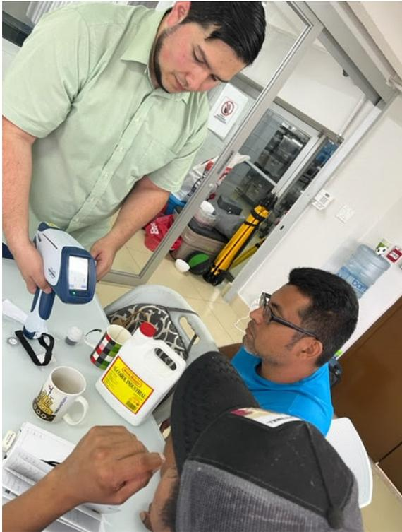
Se adquirió un analizador de espectroscopia de fluorescencia de rayos X (XRF) para realizar análisis no destructivos de la composición elemental de los materiales. Este tipo de análisis puede ayudar a determinar el origen de los materiales, lo que es importante para nuestro estudio en curso sobre el comercio y el movimiento de materiales.
