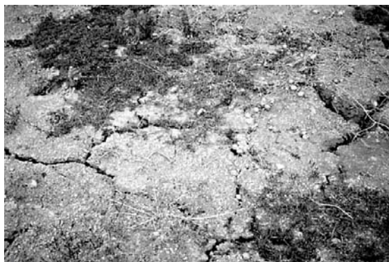
Figura 4 – Grietas de sequía en formaciones superficiales de laderas cerca de Japoto/San Jacinto Estas grietas favorecen la penetración del agua en época de lluvias
